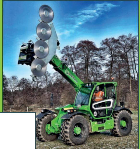
Teleskoplader mit Feldrandsäge
