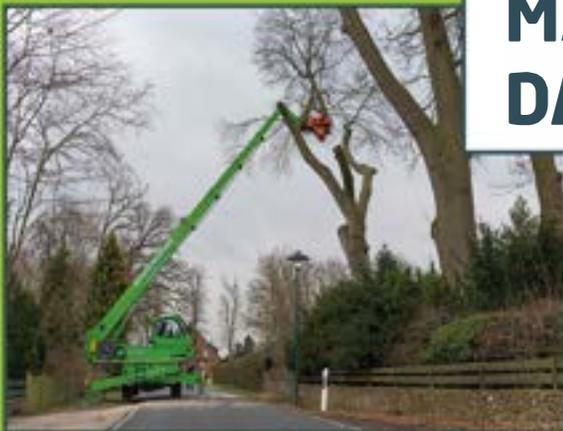
Teleskoplader mit 30m Auslage und Greifersäge mit einer Schnittbreite von 75cm
