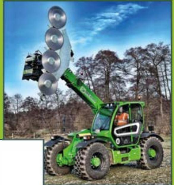
Teleskoplader mit Feldrandsäge
