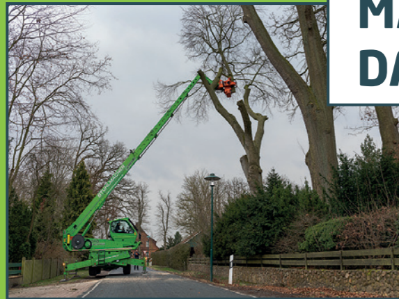
Teleskoplader mit 30m Auslage und Greifersäge mit einer Schnittbreite von 75cm
