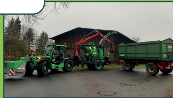
Teleskoplader: Hacker mit Kran
